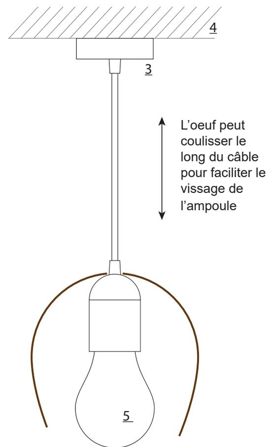
Légende : 1 : coquille - 2 : douille et câble de suspension - 3 : rosace - 4 : plafond - 5 : ampoule LED E27
